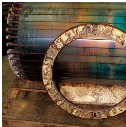
Abbildung 1: defekter Käfigläufer (Quelle: http://ecmweb.com )
