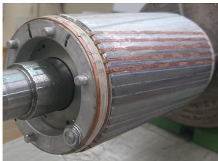
**Abb. 1:** Rotor des Prototypen mit einer Zusatzwicklung
