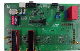
**Abb. 38:** Messplatine des HV-H<sup>3</sup>TRB-Tests
