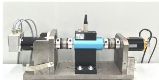
**Abb. 13:** Untersuchte PMSM (rechts) mit gekoppelter Lastmaschine (links) und Drehmomentsensor (mittig)
