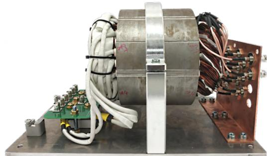
**Abb. 44:** Statorversuchsmuster mit Anschlüssen auf der rechten Seite zur Messung der Potentialverteilung
