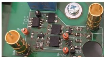
**Abb. 9:** Messschaltung zur Erfassung der Schaltzeiten von SiC-Leistungsmodulen
