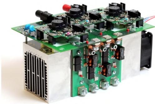
**Abb. 75:** Luftgekühlter SiC-Wechselrichter mit integriertem  $du/dt$ -Ausgangsfilter an der Seite des Kühlkörpers
