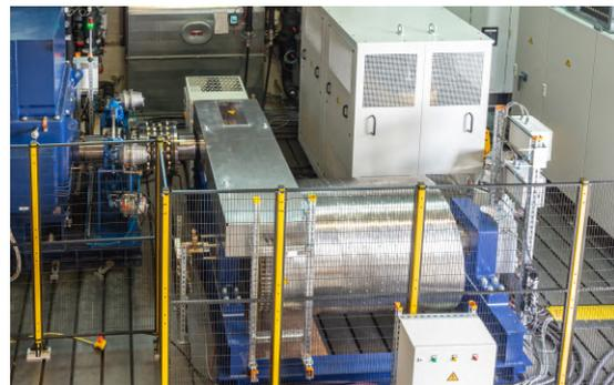
**Abb. 19:** GeCoLab Prüfstands Aufbau: SkyPower-Umrichter, Transformator, SkyPower-Generator, Kettengeräte und Lastmaschine (von rechts nach links)
