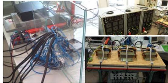
Abb. 1: Thermische Untersuchungen einzelner Statorsegmente
