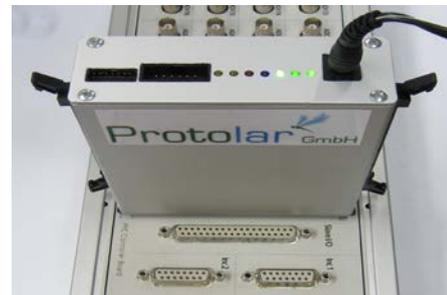
Abb.: FPGA.Comm einsatzbereit auf einem dSpace-System
