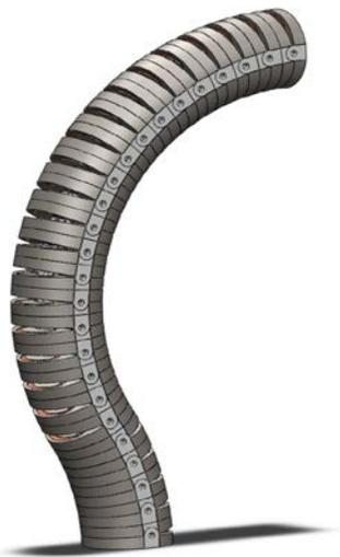
Abb. 1: CAD-Modell der Aneinanderreihung mehrerer Kippaktoren mit parallelen Kippachsen
