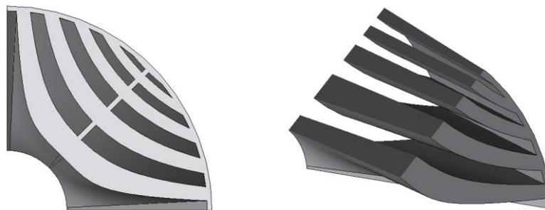
Abb. 1: Beispiel für einen dreidimensionalen Rotorentwurf einer Synchron-Reluktanzmaschine
