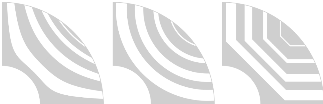
Abb. 1: Mögliche Rotortopologien von Synchron-Reluktanzmaschinen: Flussführung (links), Kreisbogen (mitte), U-Form (rechts)
