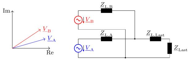
Die Abbildung zeigt ein vereinfachtes Netzmodell mit 2 netzbildenden Umrichtern und einer Last  $\underline{Z}_{Last}$  Die Umrichter sind als Spannungsquellen dargestellt, wobei die Sollspannungen  $\underline{V}_A$  und  $\underline{V}_B$  als Phasoren vorgegeben werden. Der Leistungsfluss ergibt sich aus dem Verhältnis der Leitungsimpedanzen  $\underline{Z}_{L,i}$ .
